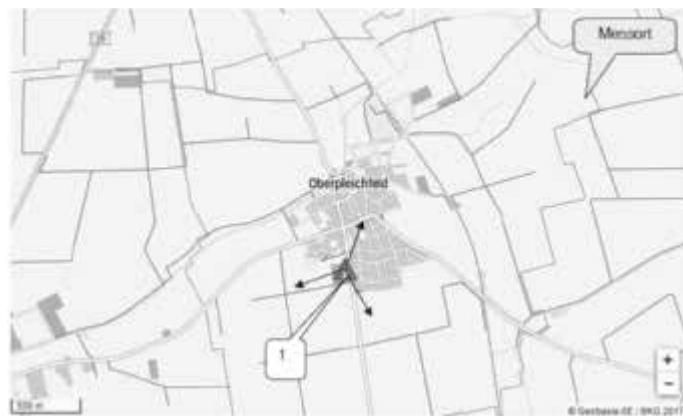
Die Pfeile zeigen die Hauptstrahlrichtungen HSR der Mobilfunksender GSM, UMTS und LTE. Es wurden nur die für den Messpunkt relevanten HSR eingezeichnet.
