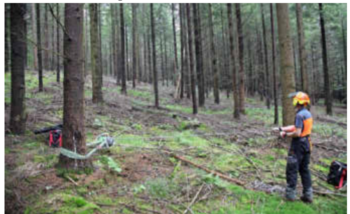
Ein sichere Alternative, wenn das Holz stimmt: Mit einer Spillwinde können hängen gebliebene Bäume unverzüglich und fachgerecht zu Fall gebracht werden. Foto: SVLFG
