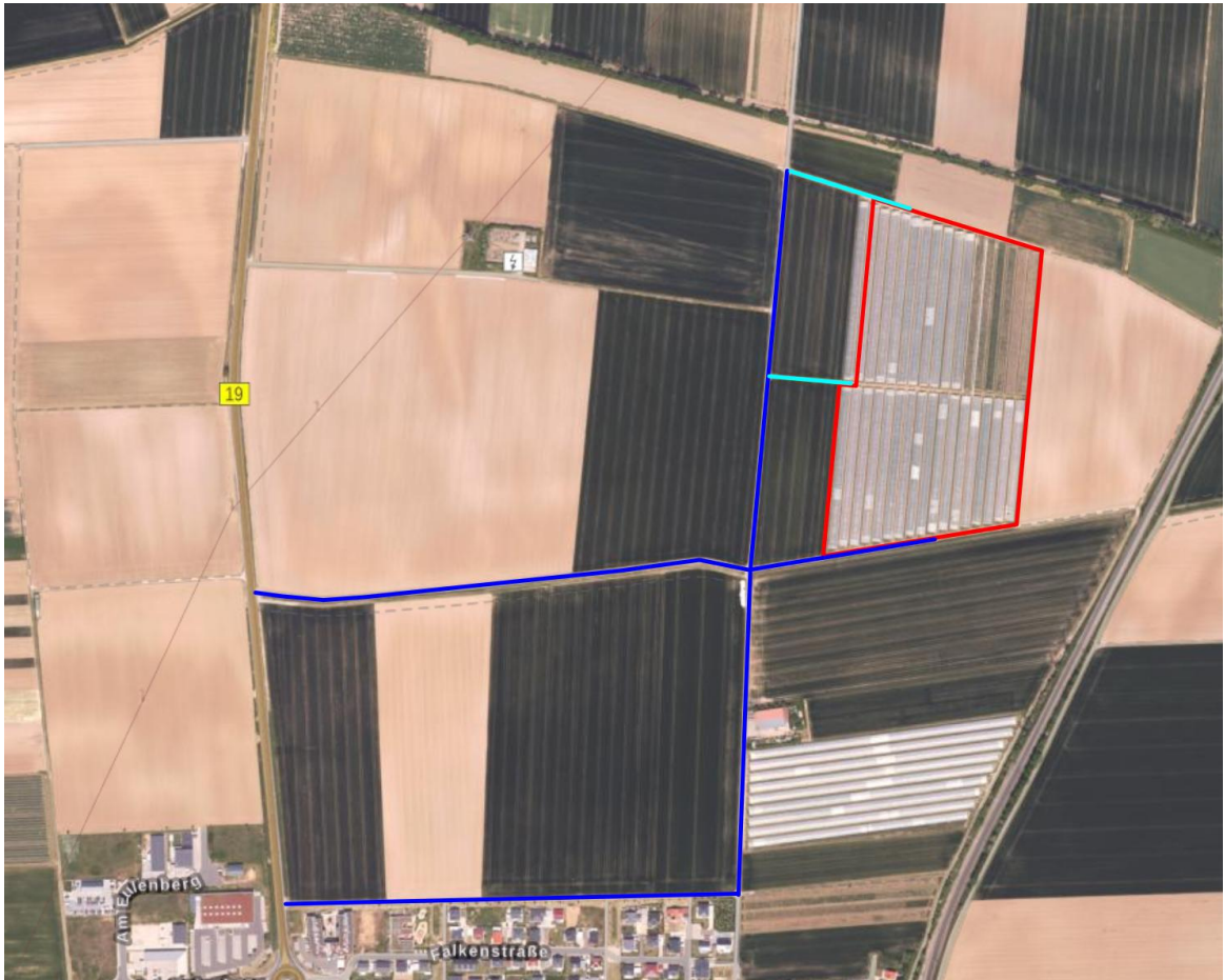
Abb.: geplantes Vorhaben (rote Umrandung) und ausgebaute Zufahrt zum Vorhaben (dunkelblaue Linie), hellblaue Linie = auszubauender Flurweg Quelle: Kartengrundlage: Geobasisdaten © Bayerische Vermessungsverwaltung 2025
